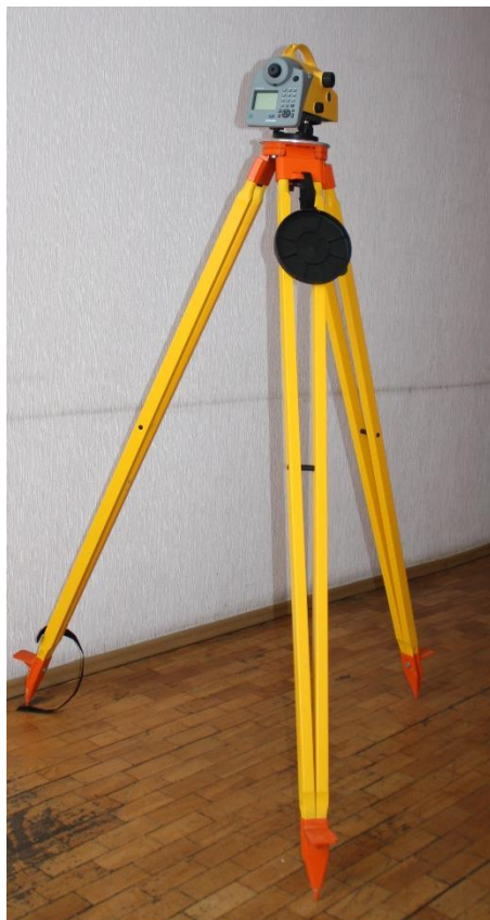
Augstas precizitātes vertikālās līmeņošanas sensors
