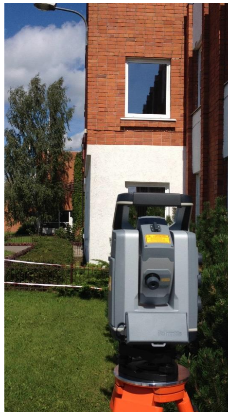
Būvju ģeometrijas parametru un konstrukciju deformāciju noteikšanas sensors
